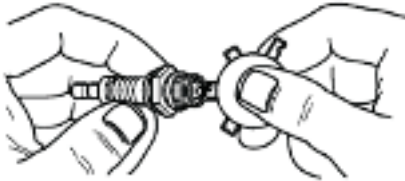
Resim-15 Buji Değiştirilmesi ve Bakımı
